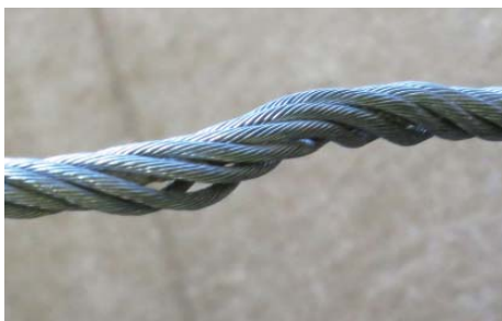
Köyden muodonmuutokset Sykkyrä, puristuma , korimuodostus, sydämen pursuaminen, rakenteen pilaava vaurio
