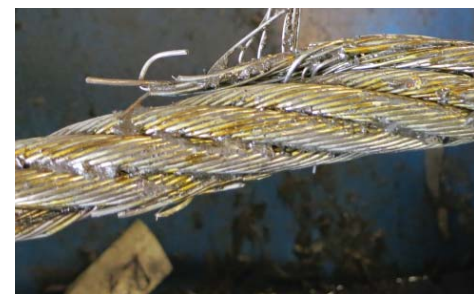
Korroosio Lankojen syöpyminen tai köyden taipuisuuden häviäminen
