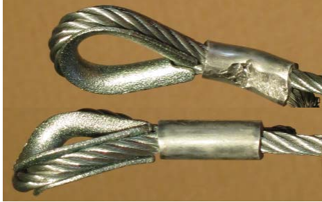
Vahingoittuneet päätevarusteet Kuluminen, muodonmuutos, halkeama
