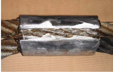
Vahingoittuneet pääteliitokset Puristusholkin kuluminen, muodonmuutos tai murtuma
